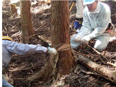
受け口切りは周囲のアドバイスが大事！ 追い口切りの高さ調整も重要です。
