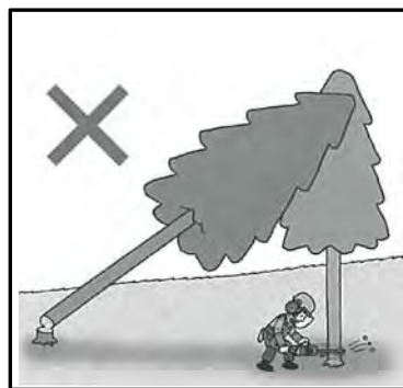
かかられている木の伐倒
